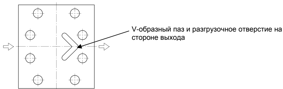
Рисунок 13.5 V-образный паз и разгрузочное отверстие на стороне выхода
