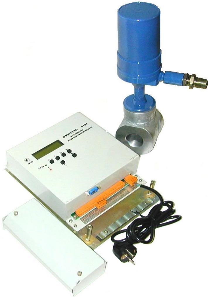
Счетчик состоит из датчика многопараметрического «DYMETIC-2721» и устройства микропроцессорного «DYMETIC-5121».
